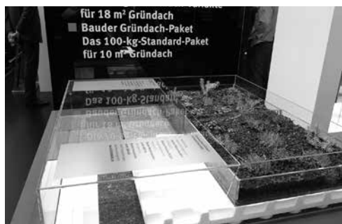
写真15 発泡スチレンを使用した軽量屋根を作り屋上緑化を行う例
