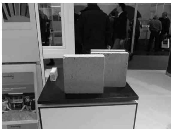
写真30 フラウンホーファー研究所が展示する未来の断熱材「発泡木毛繊維断熱材」
