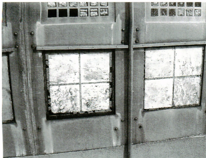
写真6 ドイツのフラウンフォーファー研究所 (Holzkirchen) で行われる各種建材に対する曝露試験
