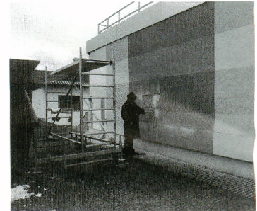
写真9 ドイツのフラウンフォーファー研究所 (Holzkirchen) では外断熱の仕上げ材、断熱材を変えて長期にわたり耐を施した実験住宅内でサーマルマネキンを使用し温熱環境の研究も行われている
