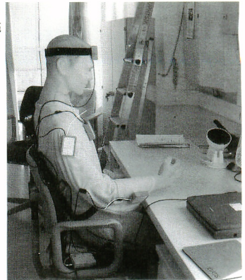
▶写真8 ドイツのフラウンフォーファー研究所 (Holzkirchen) では外断熱を施した実験住宅内でサーマルマネキンを使用し温熱環境の研究も行われている
