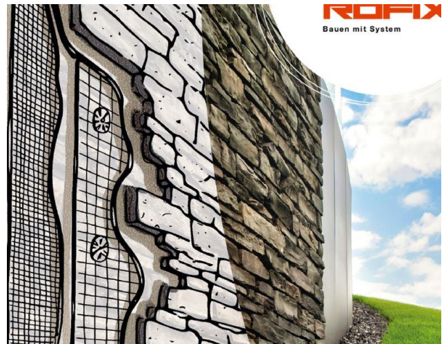
写真-4 表面を石貼り仕上げとした湿式外断熱
