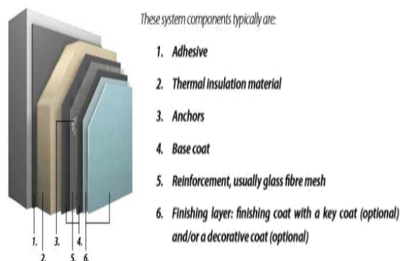
図-2 湿式外断熱の構成
