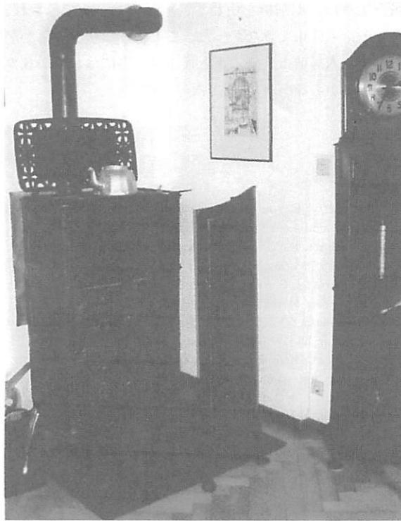
図17 暖炉からの直接の熱放射を抑えるための暖炉スクリーン。
