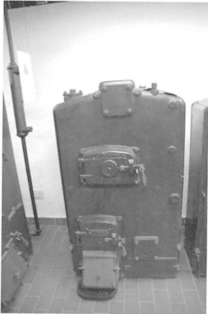
図-18 ブデルス社、鑄鉄製セクショナルボイラ (ブデルス社暖房博物館所蔵)
