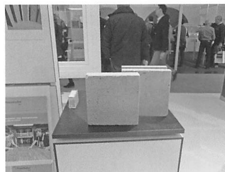
写真-16 フラウンホーファー研究所が開発した発泡木毛繊維断熱材
