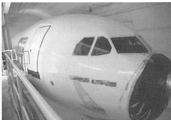
写真-4 ホルツキルヘンのフラウンホーファー建築物理研究所の航空機室内気候実験装置
