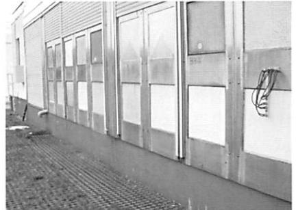
写真10 フラウンホーファー研究所（Holzkirchen）での外断熱耐候性試験（室内側は恒温恒湿に保たれている）
