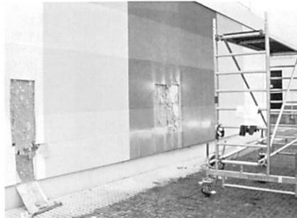
写真9 フラウンホーファー研究所（Holzkirchen）での外断熱耐候性試験
