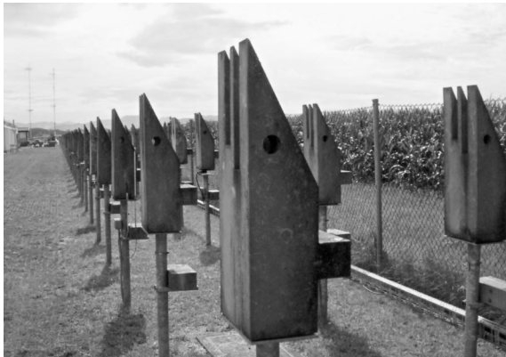
写真7 フラウンホーファー研究所の屋外曝露実験場におけるコンクリート試験体
