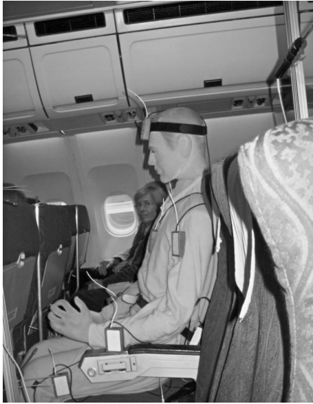
写真5 エアバスで室内温熱環境実験に使用されるサーマルマネキン
