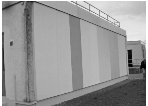
写真8 フラウンホーファー研究所における外断熱工法の曝露試験
