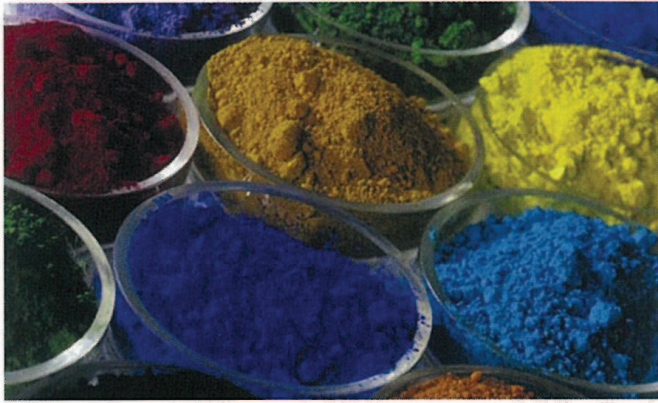
写真1 原料は天然材料でかつ無機塗料であるので、紫外線に対し安定性がある。
