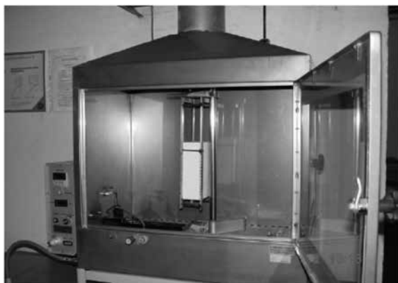
写真9 欧州規格 EN13501-1 で規定されている火室 (Fire Box) 法による試験装置
