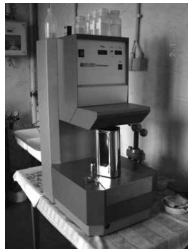
写真8 欧州規格 EN13501-1 で規定されている建材の難燃性を試験するカロリメーター
