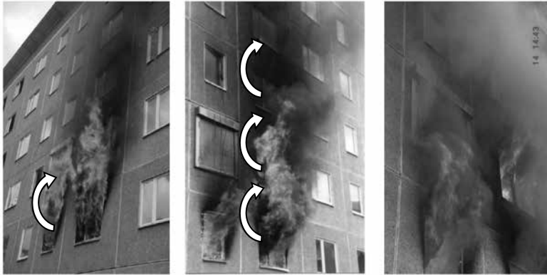
写真6 火炎が上階へ昇る状態の実物火災実験の様子
