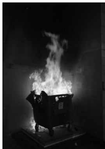
写真2 建物外壁に近接したゴミ収集コンテナから火災が発生した例
