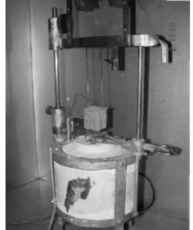
写真7 欧州規格 EN13501-1 で規定されている建材の難燃性を試験する炉
