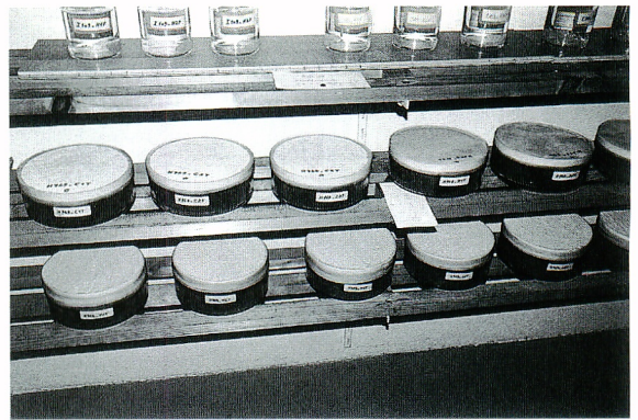
写真4 各種材料の透湿度試験 (Fraunhofer 研究所)
