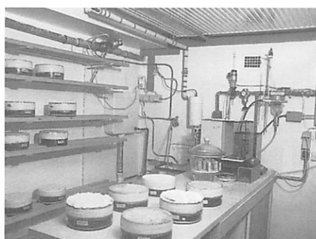
各種建材のカップ法による透湿率の試験
