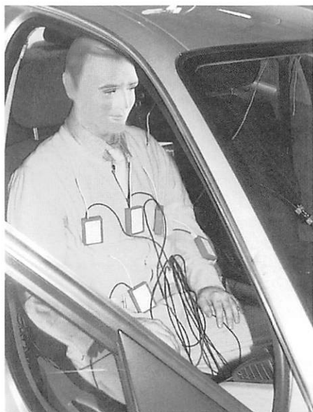
温熱環境の研究。サーマルマネキンを用い事務所建築のみならず、自動車、航空機についても行われる。(Stuttgart)
