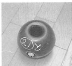
Photo5 付設温室に設置する潜熱蓄熱体
