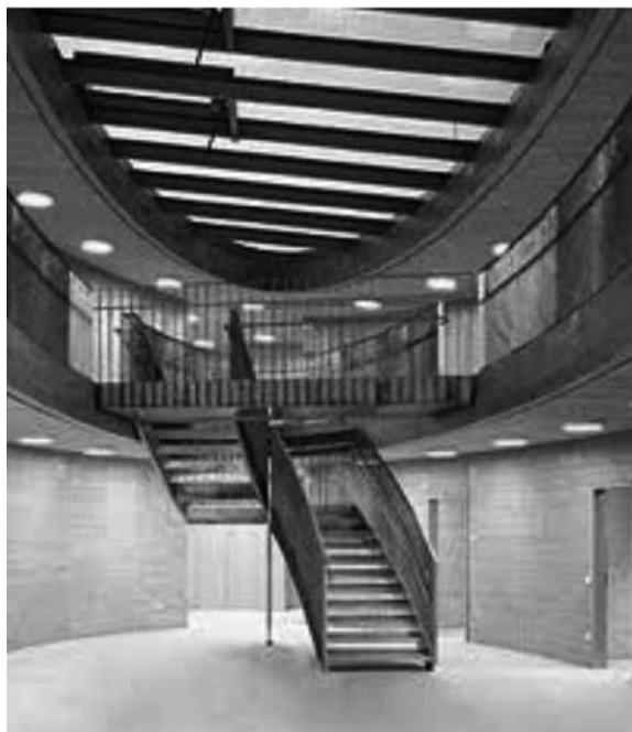
図12 湾曲した BSH (CLT) を使用した室内仕上
