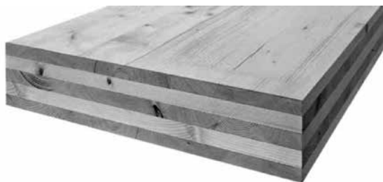
図1 BSH (CLT)の例「ひき板の繊維方向が層ごとに直交するように重ねて接着したパネル」(Poppensieker & Derix GmbH & Co.KG)
