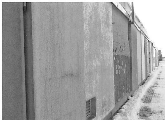
写真 20 各種構成による外断熱の耐候性試験
