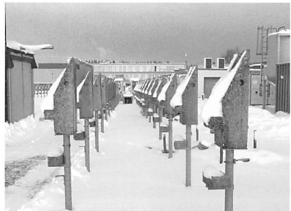
写真17 フラウンホーファー建築物理研究所で長期にわたり行われている建築部位の耐候性試験(教会の尖塔を模した試験体)
