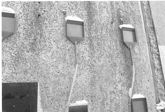
写真 19 壁体にあたる雨量の測定と壁体内の透湿試験
