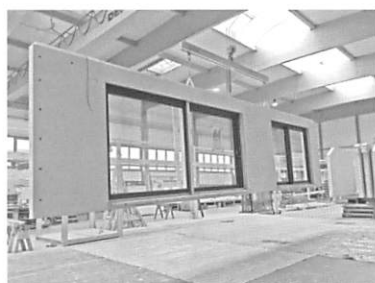
図 24 ガラス窓を組み込んだコンクリート製外壁パネルの工場生産
