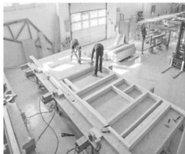
図 21 工場における木造パネルの製造
