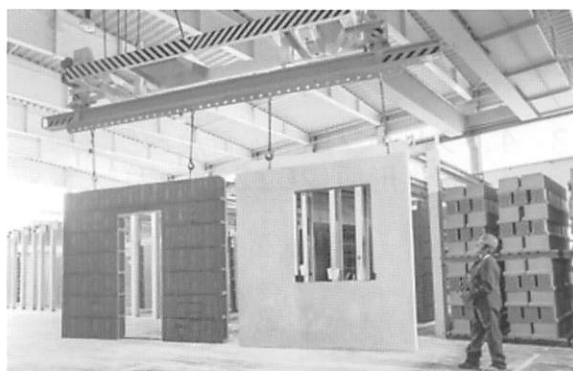
図16 工場生産の外壁パネル
